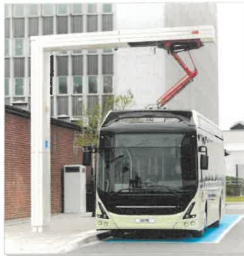
Slika: Prostostoječa polnilna postaja z dvema polnilnima mestoma in pantograf na drogu
