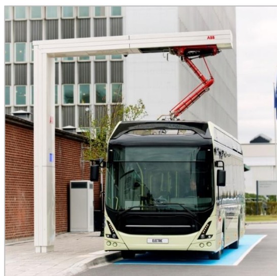
Primer pantografske polnilne naprave (Vir: DIIP-2)
