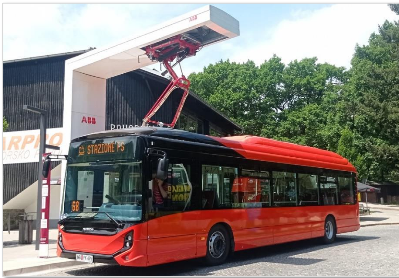
Slika 1: Pantograf pri postajališču Vzpenjača
