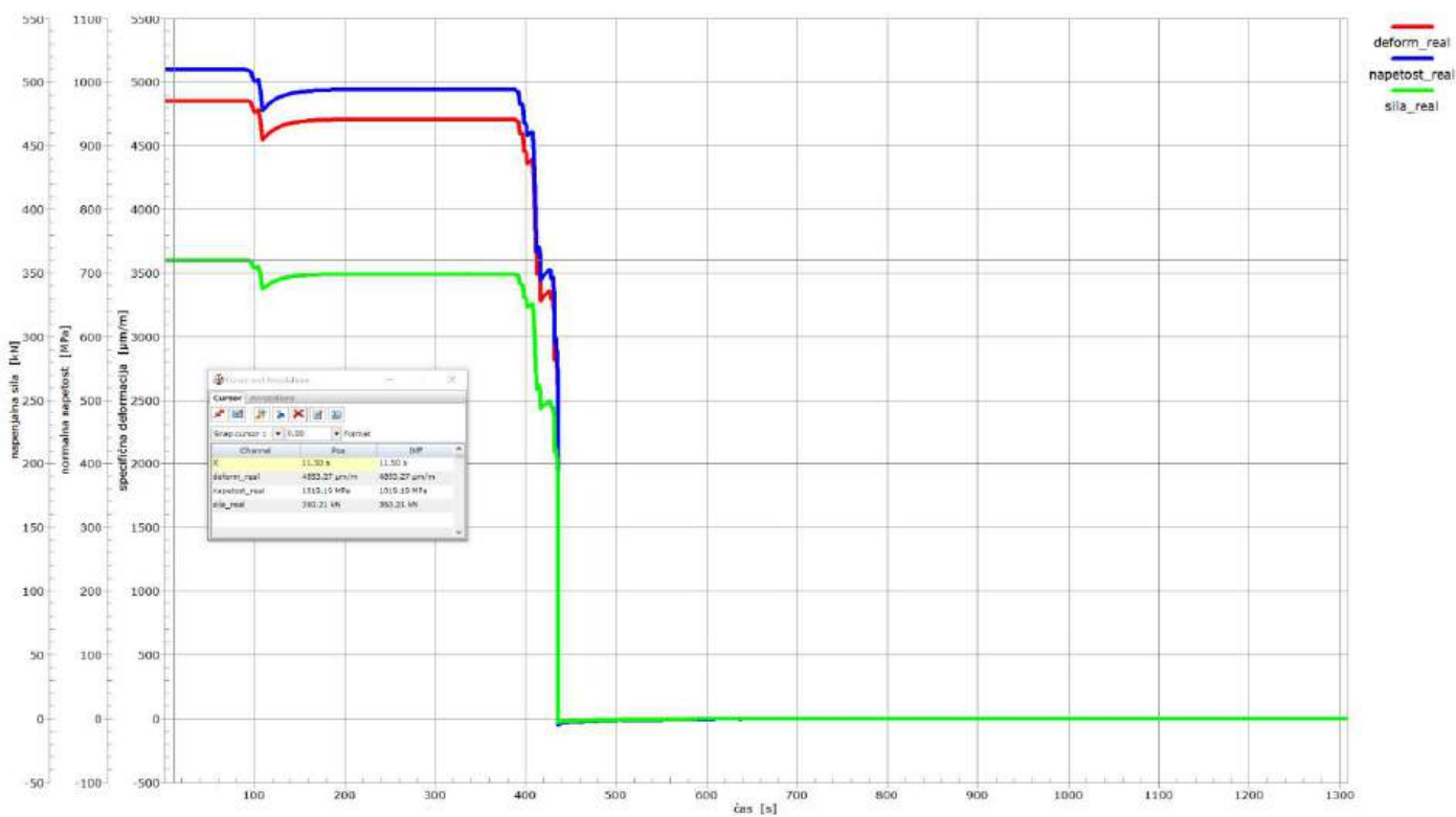
Slika 12: Grafični prikaz časovnega poteka izmerjenih specifičnih deformacij ter izračunanih napetosti in nopenjalne sile pri dejanski izhodiščni vrednosti specifičnih deformacij, ki so dobljene tako, da je pedhodno nulirana izhodiščna vrednost premaknjena za vrednost končne izmerjene vrednosti specifične deformacije; prikaz je narejen za eno merilno mesto v prekladni konstrukciji (druga verzija prikaza – dejansko stanje deformacij in napetosti po razbremenitvi)
