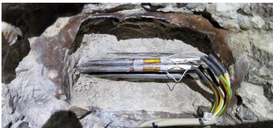
Merilni lističi nalepljeni na predhodno očiščeni površini dveh žic
