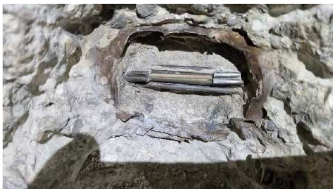
Slika 4: Izrezani dve žrtvovani jekleni žici po izvedbi testa
