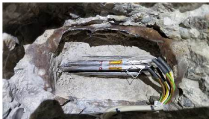
Slika 3: Merilni lističi nalepljeni na predhodno očiščeni površini dveh žic
