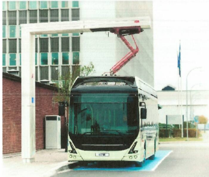
Slika 2: Primer pantografske polnilnice
