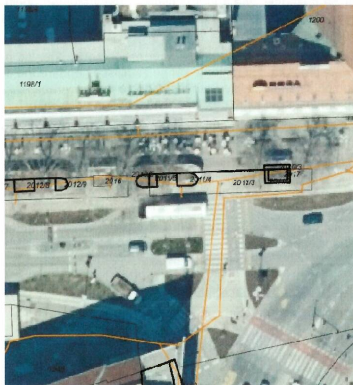
Slika 8: Pod in ob objektu poteka TK vod.
