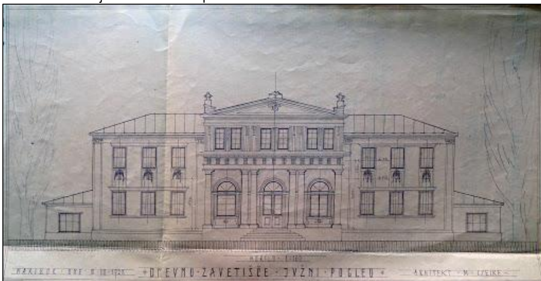
Slika 3: Načrt za južno fasado s timpanonom
