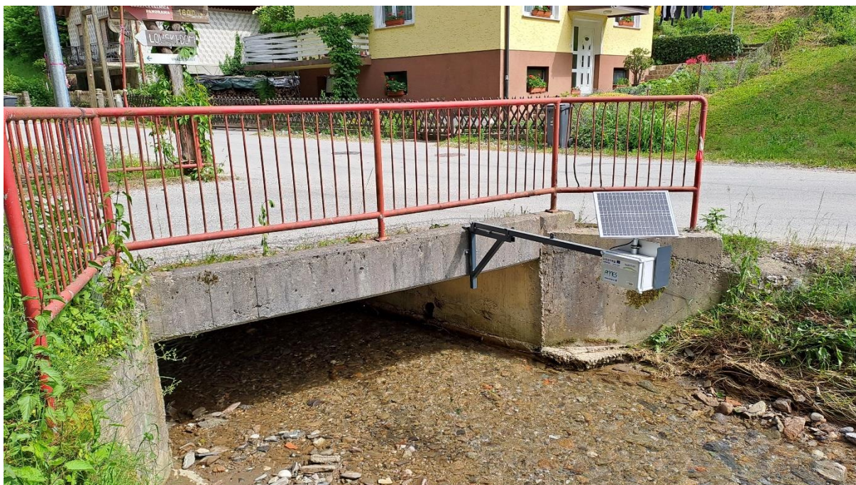
Slika vgrajenega merilnika gladin na Kamniškem potoku
